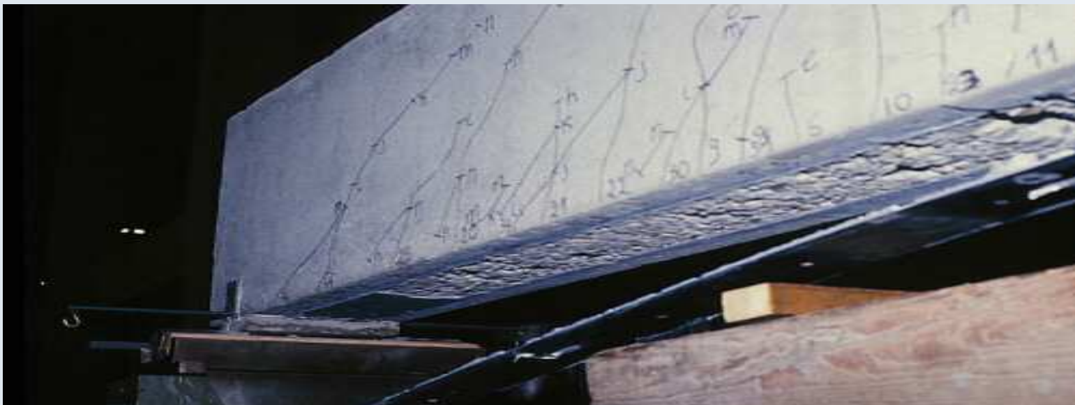
Αναλαμβανόμενη δύναμη επικολλητών φύλλων συναρτήσεως του μήκους αγκύρωσης
